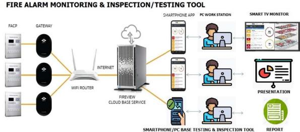
SMARTPHONE/PC BASE TESTING & INSPECTION TOOL
